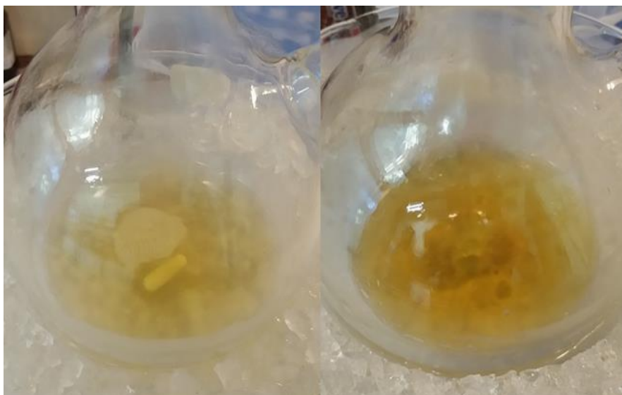
Εικόνα 22: Διάλυμα της Boc-His(Trt)-OH σε THF πριν (αριστερά) και μετά (δεξιά) την αντίδραση με το \text{SOCl}_2 .
