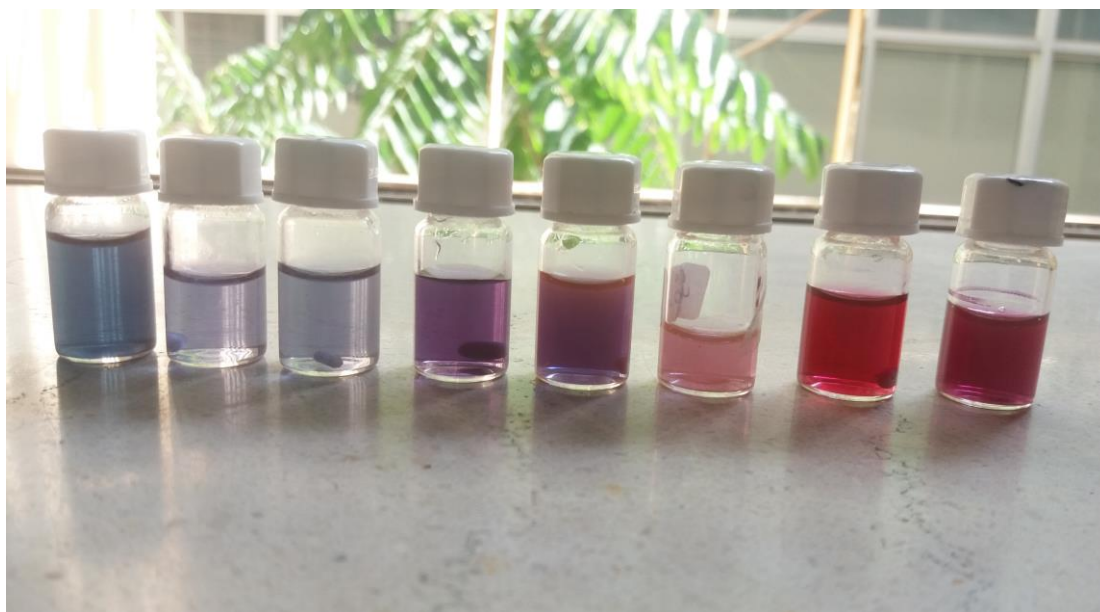
Εικόνα 33: Μεταβολή των οπτικών ιδιοτήτων των διαλυμάτων των νανοσωματιδίων χρυσού σε διάφορες αναλογίες mol His/mol Au(III).
