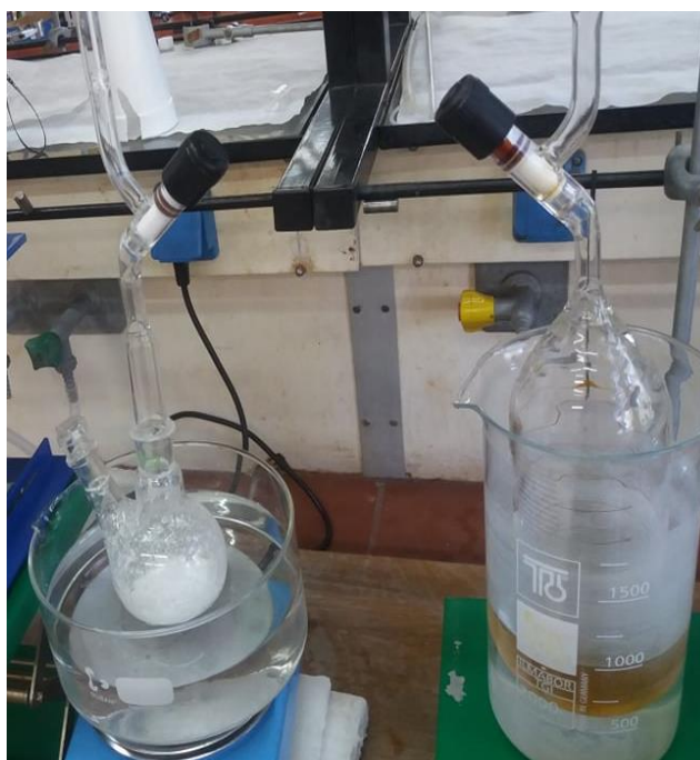
Εικόνα 20: Απόσταξη βενζολίου για απομάκρυνση υγρασίας.
