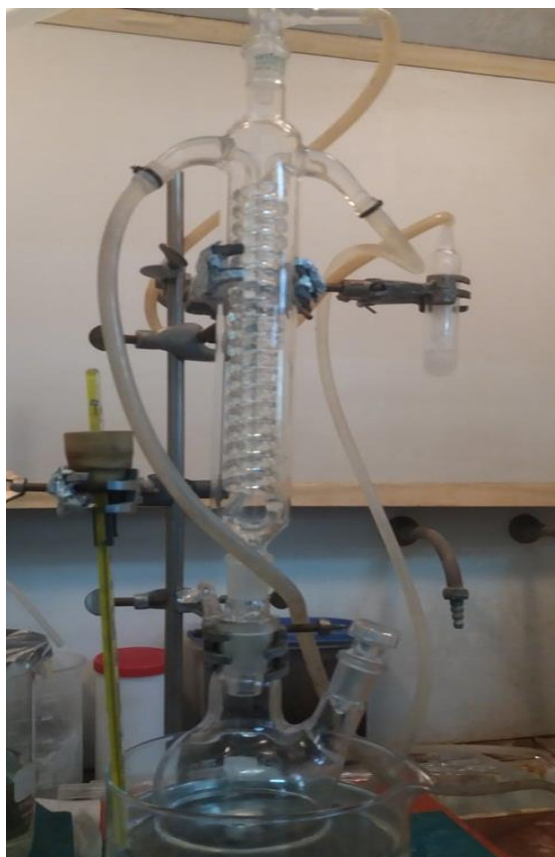
Εικόνα 21: Κατάλληλη διάταξη για μετατροπή PEO-OH σε PEO-NH 2 .
