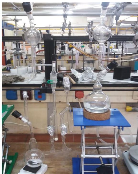
Εικόνα 26: Απόσταξη διαλύτη DMF.
