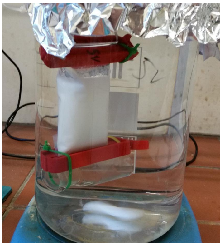
Εικόνα 29: Διαδικασία διαπίδυσης για την απομάκρυνση των τρίτυλο-προστατευτικών ομάδων.
