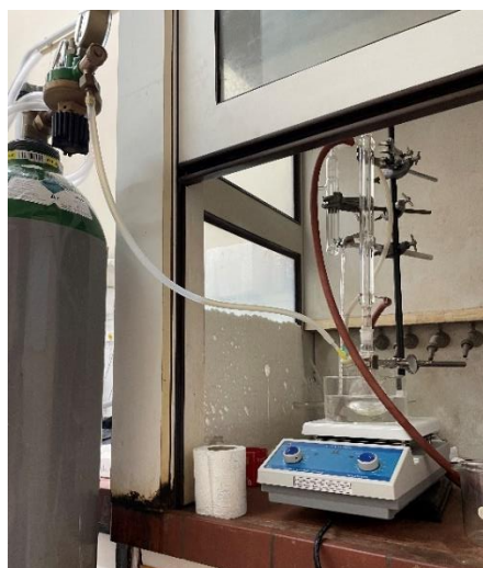
Εικόνα 42. Διάταξη αντίδρασης σύνθεσης μακροαπαρηχτή.
