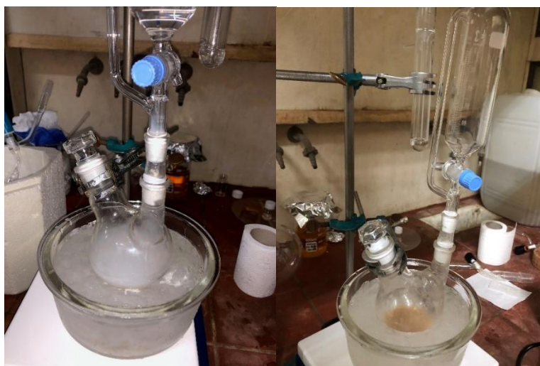
Εικόνα 38. Στάγδην προσθήκη διαλύματος άλατος \text{CF}_3\text{SO}_2\text{NH}_2 υπό ροή αερίου \text{Ar} .
