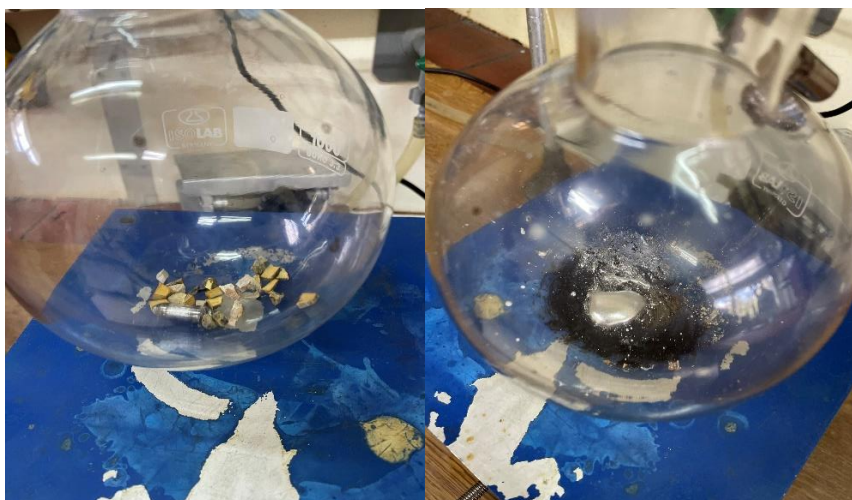
Εικόνα 35. Σχηματισμός κράματος K-Na σε Schlenk υπό κενό και με χρήση θέρμανσης.
