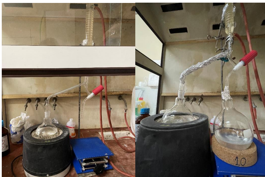
Εικόνα 34. Διαδικασία ξήρανσης του THF με αντίδραση με μεταλλικό Na.
