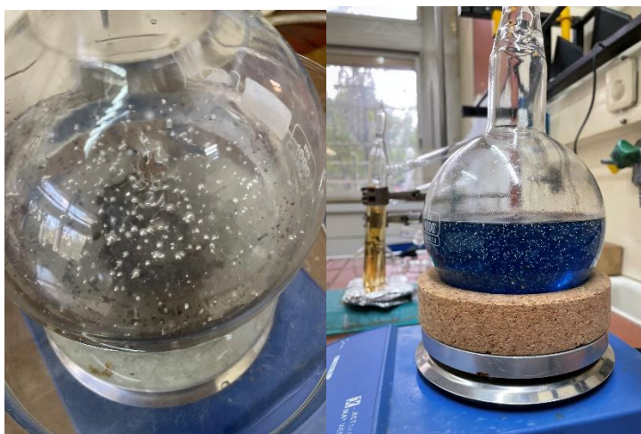
Εικόνα 36. Πορεία αντίδρασης και χρωματισμού του THF με το alloy K-Na.
