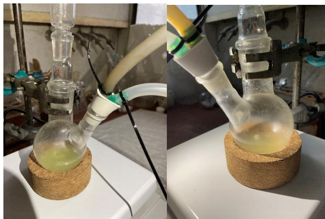
Εικόνα 44. Αντίδραση Williamson και μικρή αλλαγή χρώματος του διαλύματος μέσα σε 43 ώρες.
