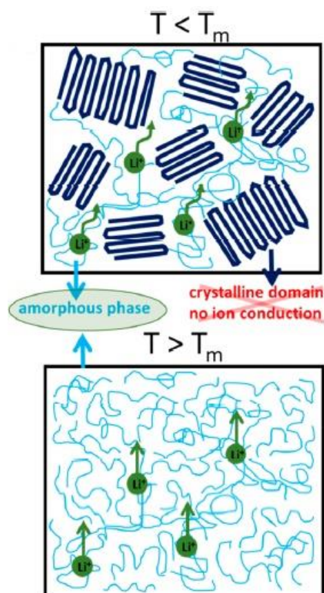
Εικόνα 24. Σχηματική απεικόνιση της μεταφοράς ιόντων Li + στους PEO ηλεκτρολύτες σε θερμοκρασίες T > T m και T < T m . (23)
