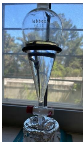
Εικόνα 50. Κλασματοποίηση του μείγματος προϊόντων του πολυμερισμού.
