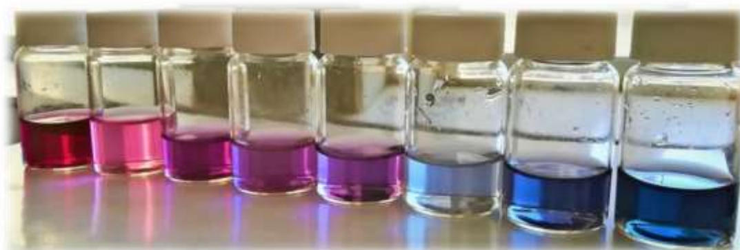
Εικόνα 27: Ρυθμιζόμενες οπτικές ιδιότητες των AuNPs προσαρμόζοντας το πάχος του κελύφους χρυσού, με τη μεταβολή του HAuCl 4 στη συνθετική πορεία
