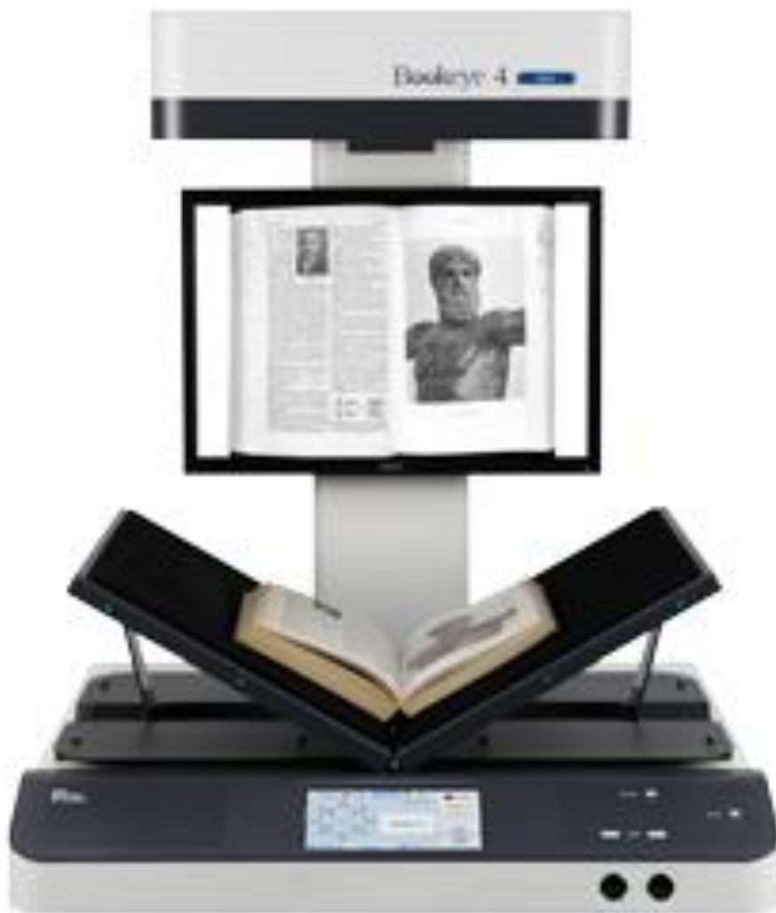
(εικ. 9) α. Ο σαρωτής Bookeye 4 V2 με γωνία επιφάνειας σάρωσης 120°
