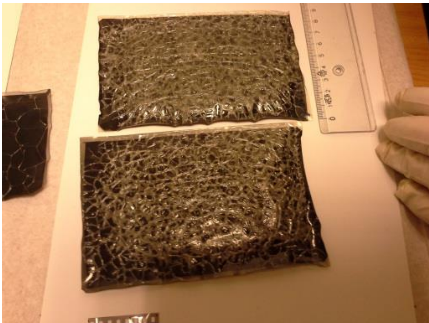
(εικ. 12) Προχωρημένο στάδιο φθοράς αρνητικών οξικής κυτταρίνης, λόγω του συνδρόμου του ξυδιού. (πηγή: athensconservation-Κίτσοσ Μακρήσ )
