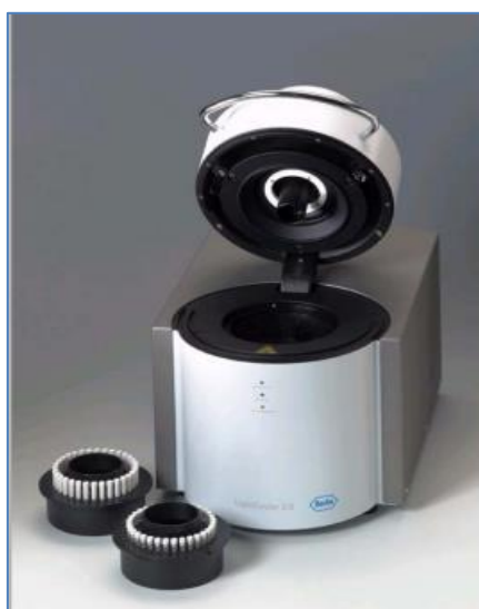
Εικόνα 4.5.: Light Cycler 2.0. και ο περιστρεφόμενος δίσκος με τα γυάλινα τριχοειδή (capillaries).
