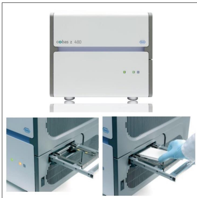
Εικόνα 4.3.: Αναλυτής Cobas z480 και η θύρα στην οποία προστίθεται η πλάκα των 96 δειγμάτων (96-well-plate).
