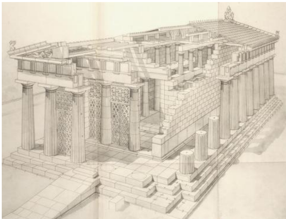
Εικόνα 39: Αποκατάσταση του ναού της Αφαίας στην Αίγινα. Διακρίνονται οι τρεις κίονες της βόρειας πλευράς που αποτελούνταν από σπονδύλους (από Furtwängler 1906, πίν. 36).
