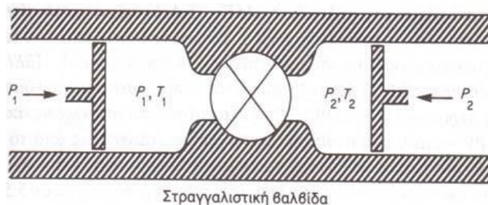
Σχήμα Π4: Εκτόνωση Joule-Thomson μέσω στραγγαλιστικής βαλβίδας Τα δύο έμβολα εξασφαλίζουν σταθερές πιέσεις κι από τις δύο πλευρές της.
