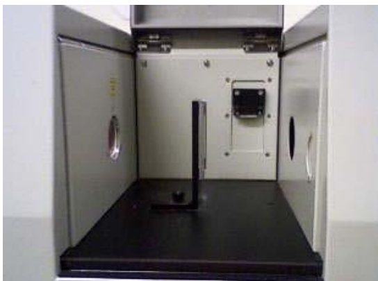
Σχήμα Π9: Το εσωτερικό του οργάνου (θάλαμος δειγμάτων) Διακρίνονται οι οπές εισόδου – εξόδου της δέσμης IR και η θήκη στήριξης του δειγματοφορέα.
