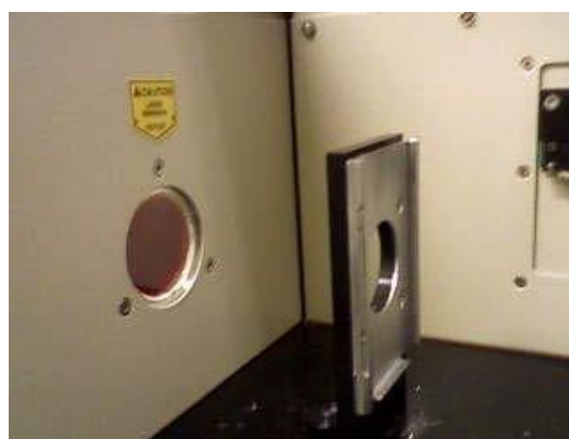
Σχήμα Π9: Το εσωτερικό του οργάνου (θάλαμος δειγμάτων) Διακρίνονται οι οπές εισόδου – εξόδου της δέσμης IR και η θήκη στήριξης του δειγματοφορέα.
