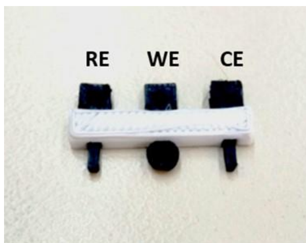
Εικόνα 5: Φωτογραφία της τρισδιάστατα εκτυπωμένης διάταξης για τον προσδιορισμό της QF και της κολχικίνης.
