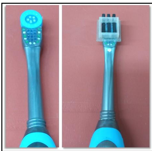
Εικόνα 9: Φωτογραφίες της τρισδιάστατα εκτυπωμένης διατάξης με τον αναδευτήρα δόνησης.
