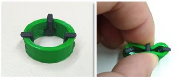
Εικόνα 13: Φωτογραφίες του αισθητήρα όπου φαίνονται το μέγεθος και η ελαστικότητα του.
