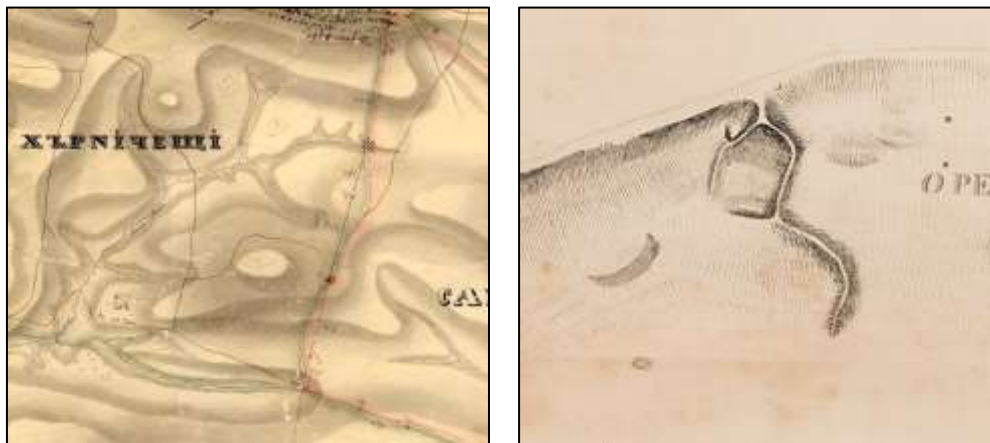
Απόδοση του αναγλύφου του εδάφους με τονική σκίαση κατακόρυφης πηγής φωτός στον χάρτη 36 (αριστερά) και με γραμμική σκίαση κατακόρυφης πηγής φωτός στον χάρτη 77 (δεξιά).
