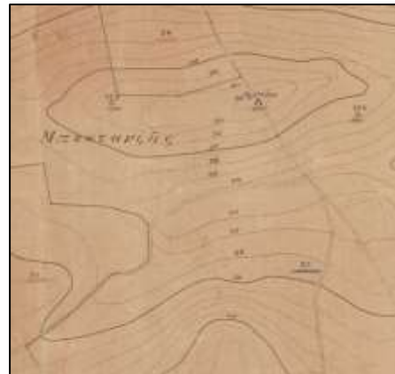
Απόδοση του αναγλύφου του εδάφους με isoυγείς καμπύλες ελεύθερης σχεδίασης στον χάρτη 69 (αριστερά) και με γεωδαιτικές και τοπογραφικές μεθόδους στον χάρτη 84 (δεξιά).
