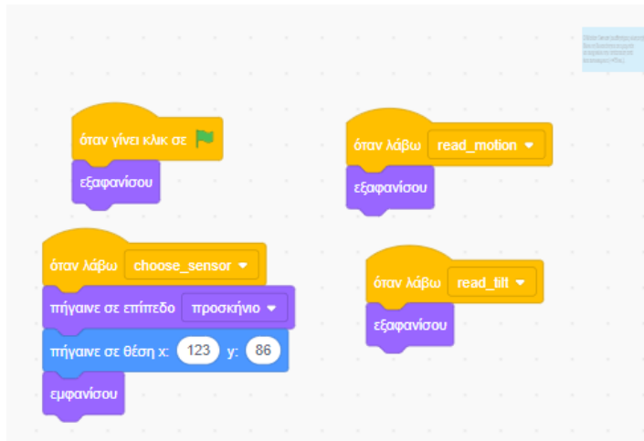
Εικόνα 70. Κώδικας για την εμφάνιση πληροφοριών του αισθητήρα κίνησης
