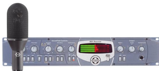
Εικόνα 2: Μικρόφωνο SoundField από την TSL [8], το οποίο κάνει τη μετατροπή μορφής A σε μορφή B στον ηλεκτρονικό προενισχυτή. 2
