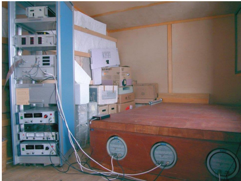
Εικόνα 2.5: Μετρητής Νετρονίων τύπου NM64 με 3 μετρητές (δεξιά φαίνονται η ξύλινη θήκη του ανακλαστήρα και οι μετρητές και αριστερά τα ηλεκτρονικά, ηλεκτρική παροχή υψηλής τάσης και το βαρόμετρο) ( http://www.nmdb.eu/ ).
