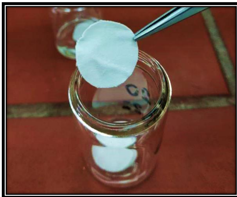
Εικόνα 6.1 Κυκλικός δίσκος διαμέτρου 1,5 cm προσροφητικού μέσου FPSE με επίστρωση sol-gel MTMS/CW20M που χρησιμοποιήθηκε στην παρούσα μέθοδο προκατεργασίας.
