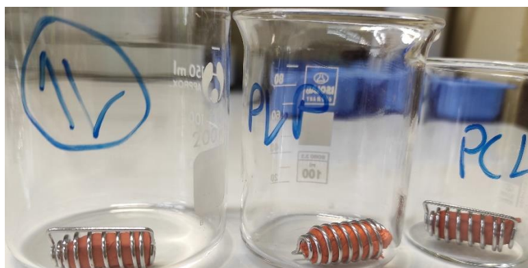
Εικόνα 29. Τεμάχια των ηλεκτροϊνοποιημένων ιών τοποθετημένα σε sinkers για τη μελέτη διάλυσης.
