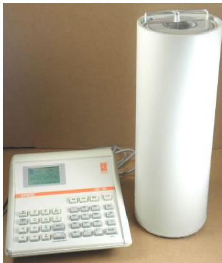
Figure 10. Βαθμονομητής ραδιοϊσοτοπικών δόσεων, Dose Calibrator, CRC-15R. Το δείγμα τοποθετείται σε ειδικά διαμορφωμένη αποσπώμενη πλαστική υποδοχή, η οποία εισέρχεται στον κύλινδρο. Έτσι, η θέση του δείγματος είναι πάντα σταθερή.
