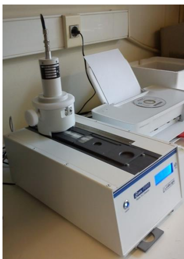
Figure 1212. Το αυτόματο ραδιομετρικό σύστημα σάρωσης χρωματογραφημάτων Scan-RAM Radio-TLC Detector αποτελείται από έναν κινητό ανιχνευτή, ο οποίος σαρώνει την ταινία χρωματογραφίας που τοποθετείται οριζοντίως στην τράπεζα. Η ανίχνευση της ακτινοβολίας γίνεται με πλαστικό σπινθηριστή NaI.
