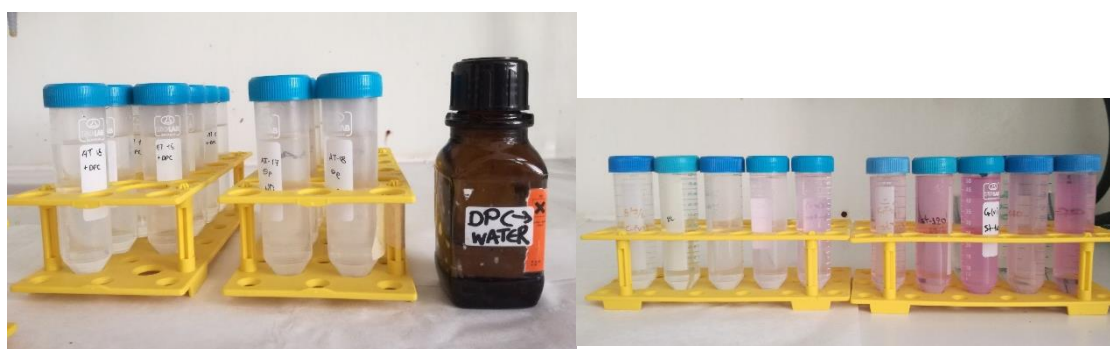
Εικόνα 3.6 Παρασκευή πρότυπων και τυφλών δειγμάτων και προετοιμασία δειγμάτων νερού για ανάλυση, σε ογκομετρικούς σωλήνες.
