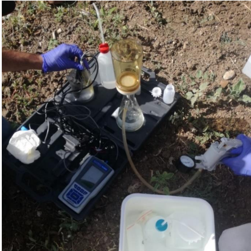
Εικόνα 3.1 Φορητό πολύμετρο με επιτόπια μέτρηση στο πεδίο και in situ δίγθηση του δείγματος νερού.
