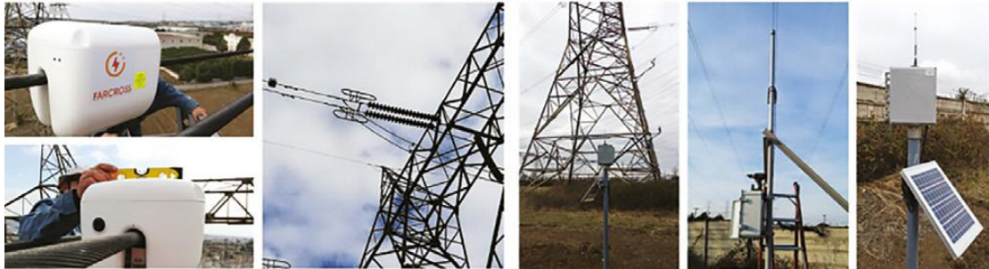
Εικόνα 42: Δύο ολοκληρωμένα συστήματα DLR στη γραμμή διασύνδεσης Ελλάδα - Βουλγαρίας, [35]
