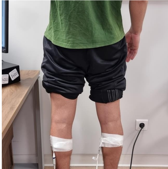
Εικόνα 3.2. Οι αισθητήρες τοποθετούνται στις έσω κεφαλές των γαστροκνημίων μυών αμφοτερόπλευρα και ο εξεταζόμενος κάμπει την ποδοκνημική με την δράση των γαστροκνημίων μυών και παραμένει στη θέση αυτή.
