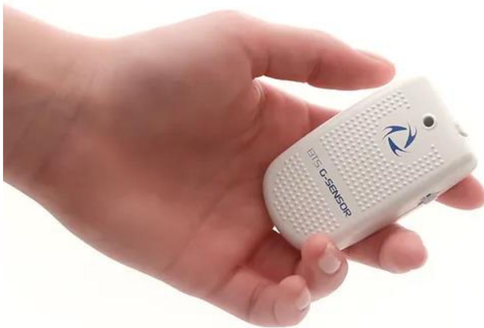
Εικόνα 1.1. Η συσκευή G Walk διαθέτει 4 αδρανειακούς αισθητήρες.
