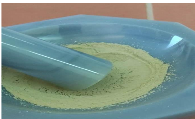
Εικόνα 84. Το χρησιμοποιούμενο αγάτινο γουδί χειρός για την επιθυμητή κονιοποίηση.
