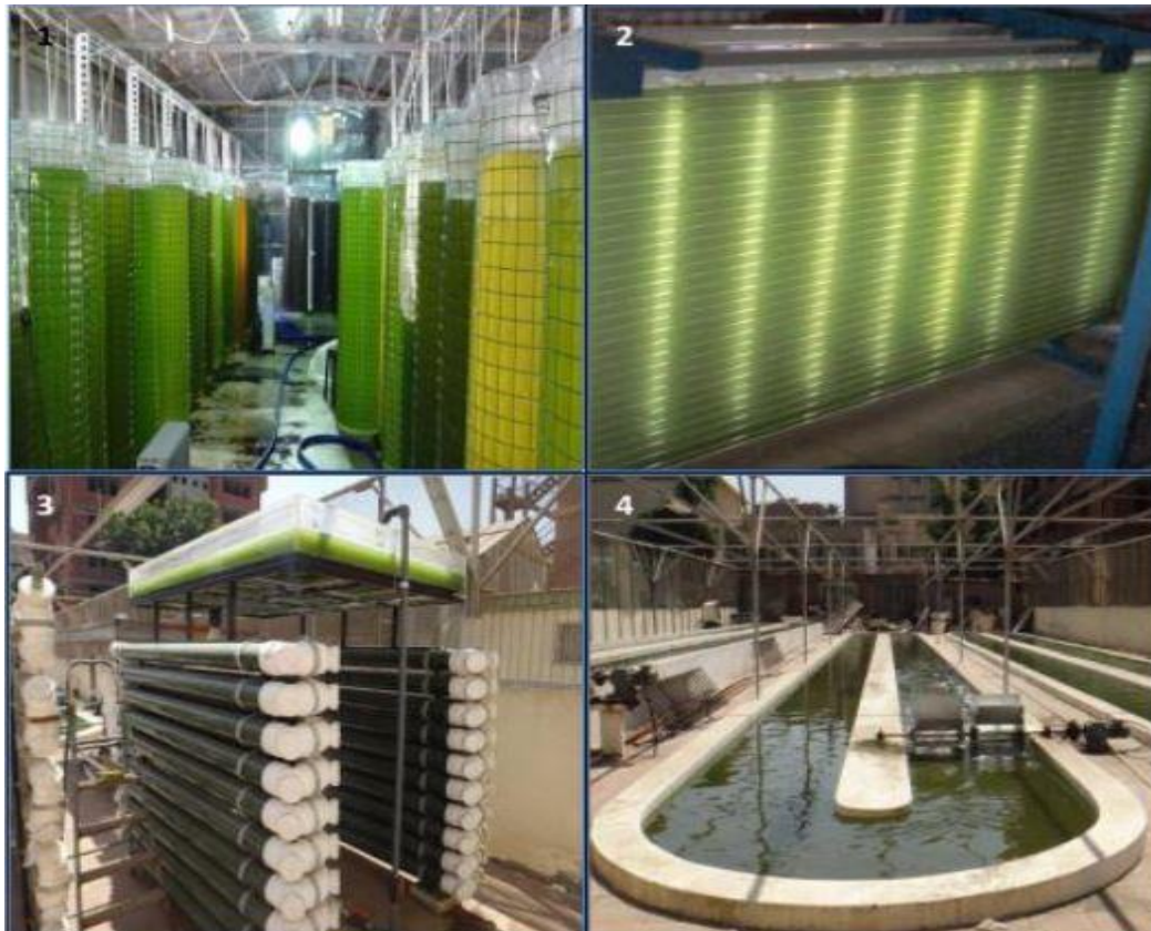
Εικόνα 4 Τύποι συστημάτων ασυνεχούς καλλιέργειας μικροφυκών. (Μάρκου et al., 2013)
