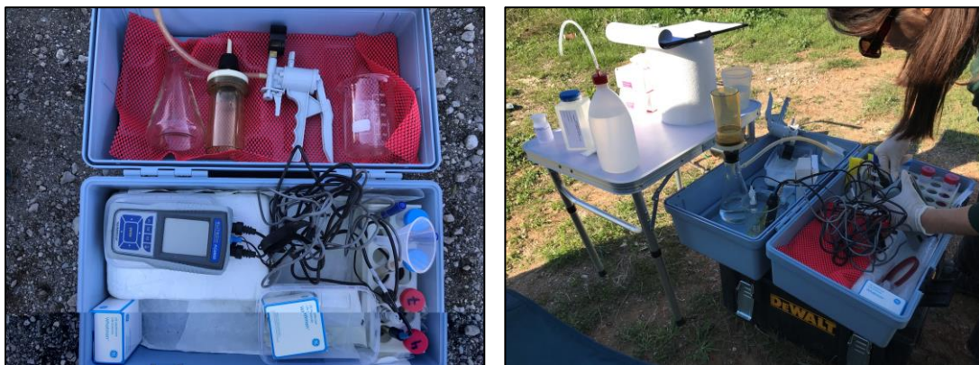
Εικόνα 12: Όργανο μέτρησης φυσικοχημικών παραμέτρων και συσκευή διήθησης με αντλία χειρός στο πεδίο
