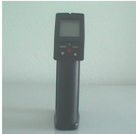
Σχήμα 6.2: Το θερμόμετρο υπέρυθρων που χρησιμοποιήθηκε για τη μέτρηση των επιφανειακών θερμοκρασιών.
