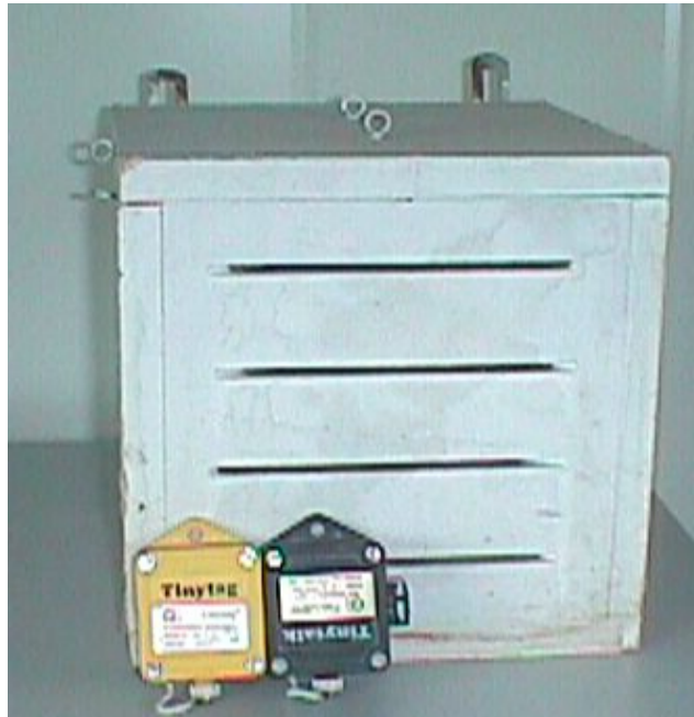
Σχήμα 4.2.: Η τελική μορφή του ξύλινου κουτιού το οποίο χρησιμοποιήθηκε για την καταγραφή των θερμοκρασιών του αέρα.
