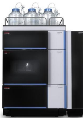
Εικόνα 12. Σύστημα Vanquish Duo HPLC and UHPLC, όπου πραγματοποιήθηκε η LC-MS.
