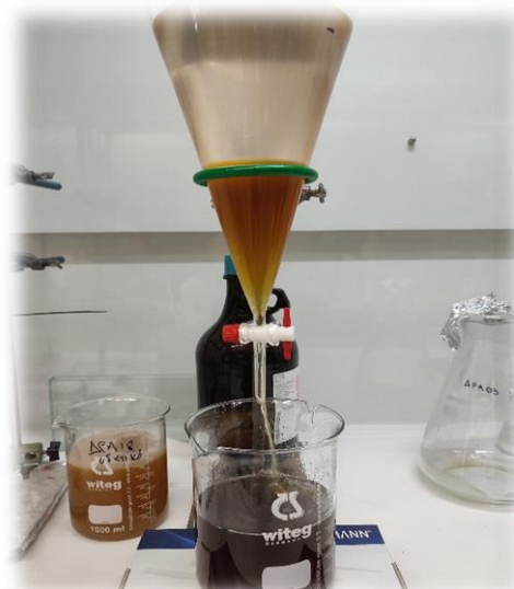
Εικόνα 18. Α. Διήθηση των εκχυλισμάτων Β. Διαχωρισμός των φάσεων με προσθήκη EtOAc σε διαχωριστική χοάνη.
