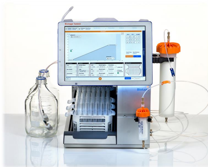
Εικόνα 11. Η συσκευή MPLC που χρησιμοποιήθηκε για την κλασμάτωση του δείγματος DPA18.
