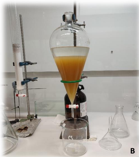
Εικόνα 18. Α. Διήθηση των εκχυλισμάτων Β. Διαχωρισμός των φάσεων με προσθήκη EtOAc σε διαχωριστική χοάνη.
