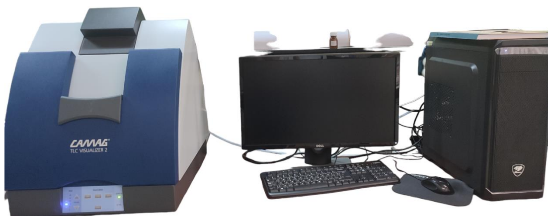
Εικόνα 9. CAMAG TLC Visualizer 2 για την παρατήρηση των TLC.
