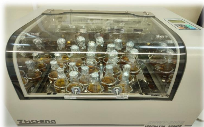
Εικόνα 15. Incubator shaker όπου επωάστηκαν οι υγρές καλλιέργειες για μία εβδομάδα. (προσωπικό αρχείο)
