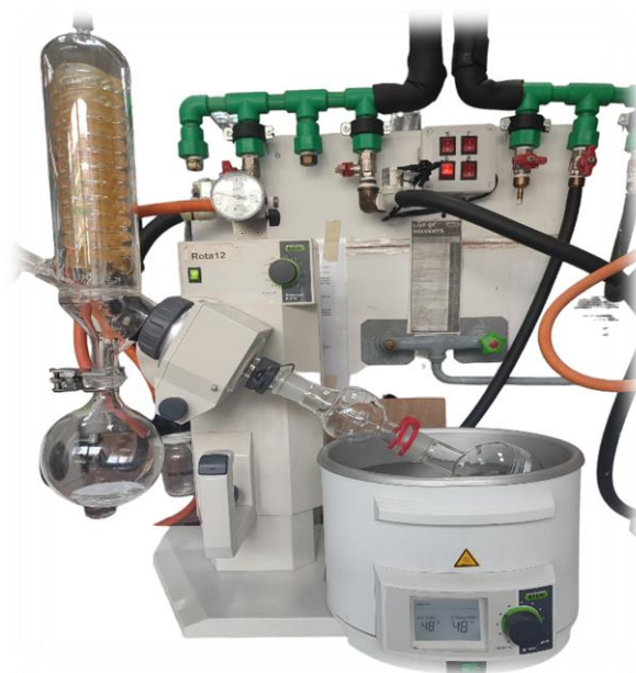
Εικόνα 8. Η συμπύκνωση των εκχυλισμάτων σε συσκευή BÜCHI Rotavapor.
