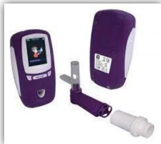
Εικόνα 13: Ο φορητός αναλυτής NO, NObreath® πρώτης γενιάς της εταιρείας Bedfont® Scientific Ltd, οποίος χρησιμοποιήθηκε για την πραγματοποίηση των μετρήσεων της μελέτης
