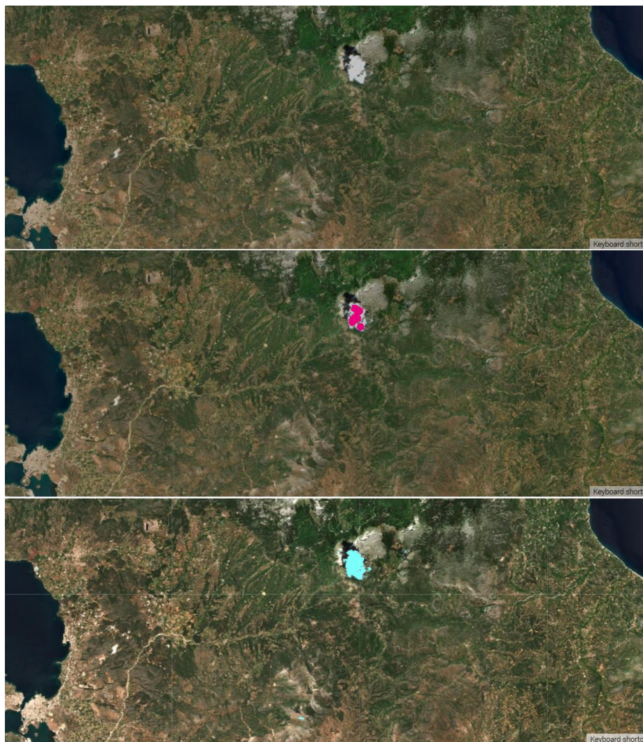
Εικόνα 6: Παράδειγμα διαφοράς της μάσκας QA60 και s2cloudless. Στην πρώτη εικόνα φαίνεται η κεντρική Εύβοια στις 26/04/2018 με ένα νέφος. Με ροζ στην επόμενη εικόνα είναι η μάσκα QA60 και με μπλε η s2cloudless
