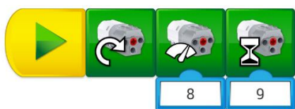
Εικόνα 80: Πρόγραμμα για δεξιά στροφή
