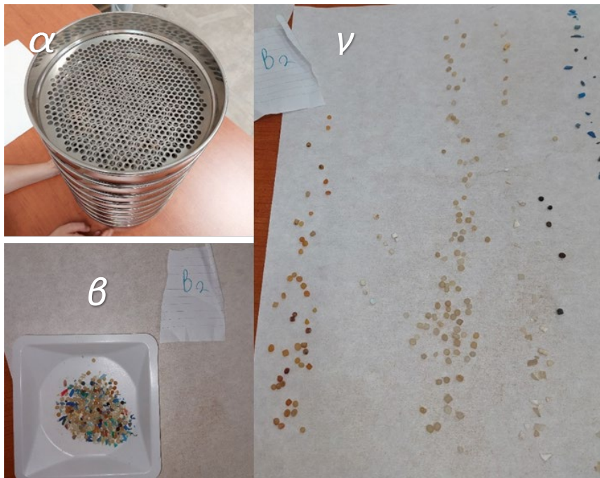
Εικόνα 7. Διαδικασία διαχωρισμού και ομαδοποίησης των πλαστικών στο εργαστήριο: (α) Σειρά κοσκίνων για αρχικό διαχωρισμό των πλαστικών σε μεγέθη, (β) κοσκινισμένο δείγμα <math><4.5\text{mm}</math>, (γ) διαχωρισμός πλαστικών βάση του χρώματος στο μέγεθος κοσκίνου <math><4.5\text{mm}</math>
