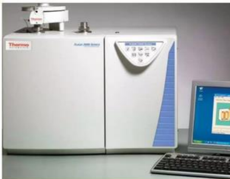
Σχήμα 2.5: Ο αναλυτής CHN της Thermo Scientific Flash EA (Series 1112).
