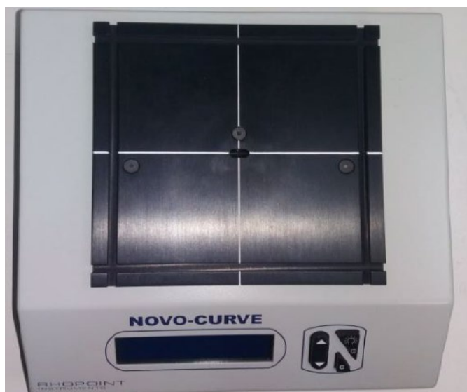
Εικόνα 35. Το κατοπτρικό στιλπνόμετρο Novo-Curve (Rhopoint Instruments) που χρησιμοποιήθηκε στην παρούσα μελέτη.
