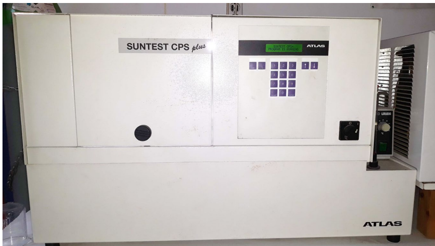
Εικόνα 32. Συσκευή φωτογήρανσης Suntest CPS plus (Atlas material testing technology, Gelnhausen, Germany) που χρησιμοποιήθηκε στη μελέτη.
