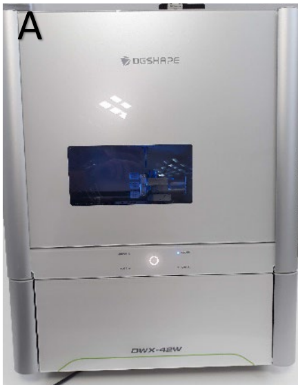
Εικόνα 31. Α) Μηχανή υγρής κοπής DGS SHAPE DWX-42W, Roland DG Corporation, Β) Προκατασκευασμένα μπλοκ τοποθετημένα στο θάλαμο της μηχανής κατά τη διάρκεια της κοπής τους.
