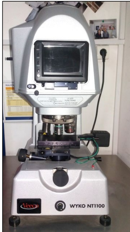
Εικόνα 36. Οπτικό προφιλόμετρο Wyko NT 1100 (Veeco, Tuscon, AZ, USA) για την τρισδιάστατη αξιολόγηση της επιφάνειας των δοκιμίων.
