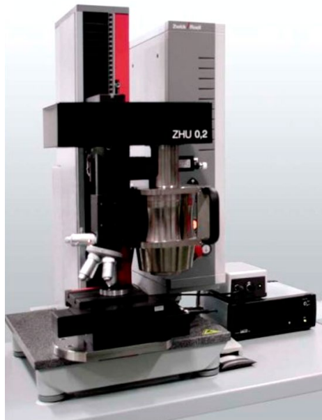
Εικόνα 29. Αναλυτική συσκευή- σκληρόμετρο ZHU2.5/Z2.5 με σύστημα ψηφιακής καταγραφής βάθους διείδυσης και φορτίου και ενσωματωμένο οπτικό μικροσκόπιο.
