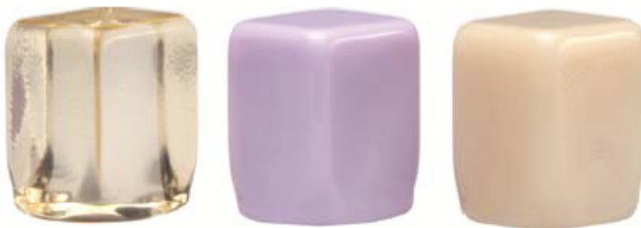
Εικόνα 2. Από αριστερά προς τα δεξιά: μπλοκ υάλου, μερικώς κρυσταλλοποιημένη «μπλε κατάσταση» (μεταπυριτικό λίθιο) και πλήρως κρυσταλλοποιημένο μπλοκ διπυριτικού λιθίου (Πηγή Scientific Documentation IPS e.max® CAD-on. 4. Technical Data & Materials Science Investigations. Ivoclar Vivadent, Schaan, Liechtenstein, October 2011 [33]).
