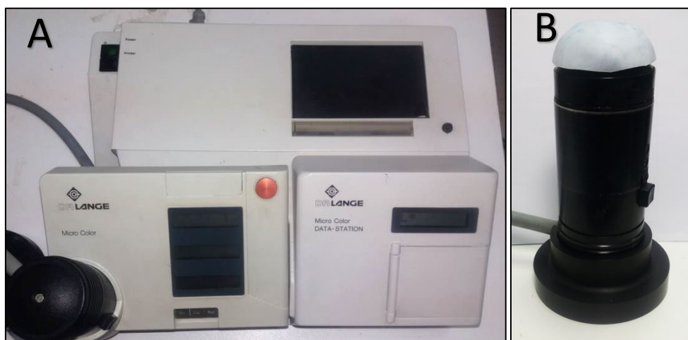
Εικόνα 34. Α) Χρωματόμετρο Dr Lange Microcolor Data Station. Β) Μήτρα σιλκόνης για κάθε δοκίμιο για την εξασφάλιση επαναληψιμότητας των μετρήσεων.
