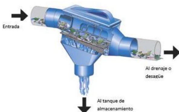
Εικόνα 8 Φίλτρο καθοδικού αγωγού (Πηγή: https://ec.europa.eu/programmes/erasmus-plus/project-result-content/0f9de572-d439-4f96-8f70-818edd99082b/AquaVET_O3-A4_Handbook_2016-07-26_EL.pdf )
