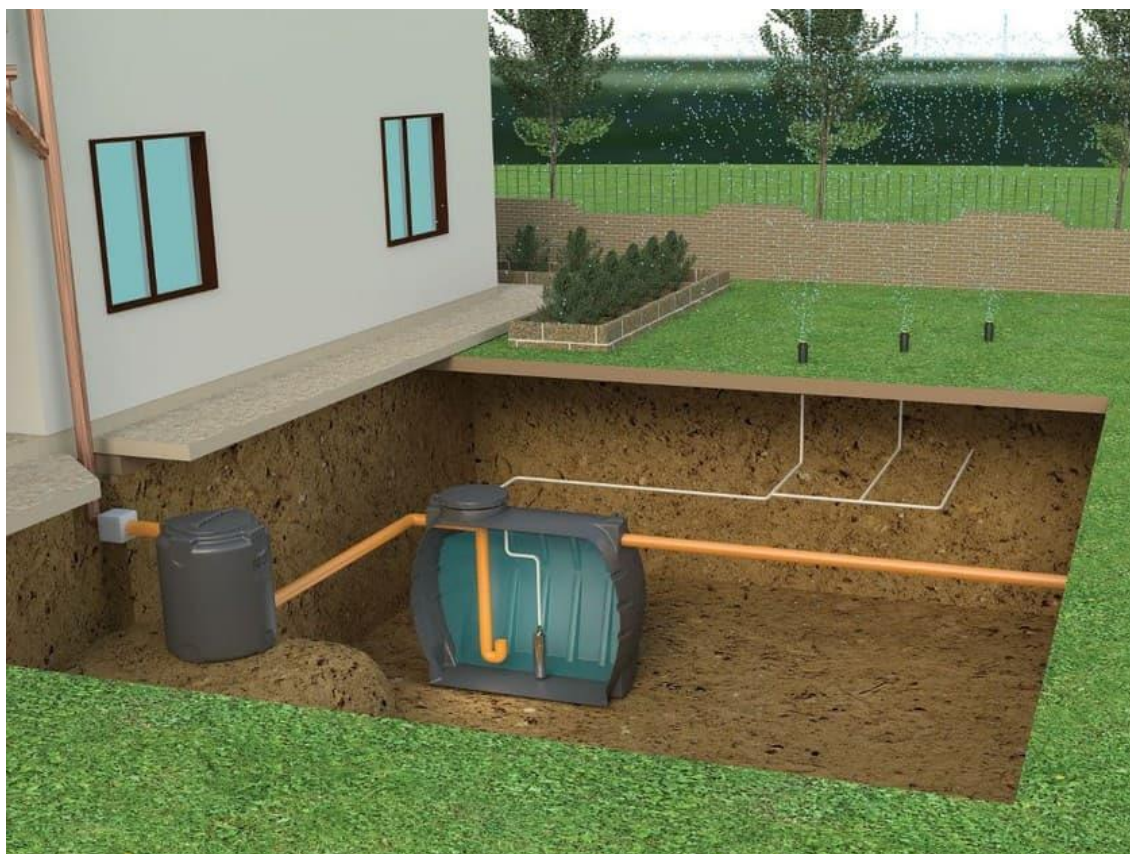
Εικόνα 13 Σύστημα συλλογής όμβριων υδάτων (Πηγή: https://enflow.gr/proionta/systemata-syllogis-apostraggisis-nerou/rainwater/ )
