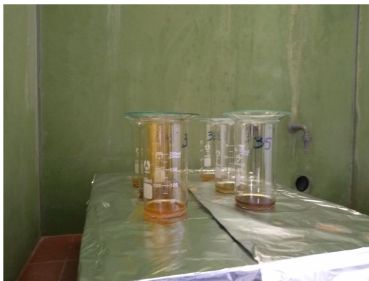
Εικόνα 2.5.4γ. Προς το τέλος του χρόνου των 30 λεπτών, τα ποτήρια ζέσεως καλύπτονται με νέλους ωρολογίου και ελέγχεται η διαφάνεια των τοιχωμάτων τους
