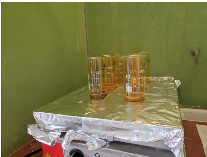
Εικόνα 2.5.4β. Γίνεται σταδιακή προσθήκη 5 ml \text{HNO}_3 ανά 30 λεπτά στα ποτήρια ζέσεως, μέχρις ότου να μην εμφανίζονται πλέον χρωματικές ενδείξεις στα τοιχώματά τους
