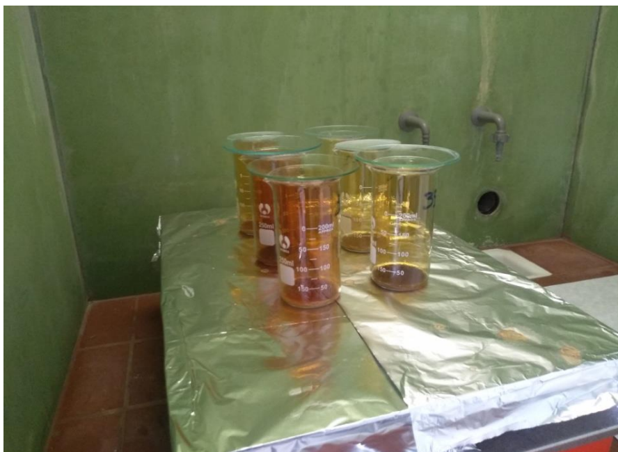
Εικόνα 2.5.4α. Τα ποτήρια ζέσεως με το ζυγισμένο εδαφικό υλικό και 10ml πυκνού \text{HNO}_3 καλύπτονται με βέλους ωρολογίου και τοποθετούνται στη θερμοτράπεζα στους 95^\circ\text{C} \pm 5^\circ\text{C}
