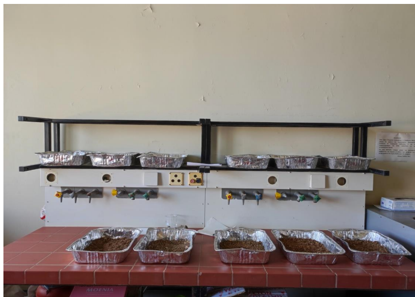
Εικόνα 2.3.1α. Τα εδαφικά δείγματα για την ξήρανσή τους αφήνονται σε ταψάκια αλουμινίου στο εργαστήριο
