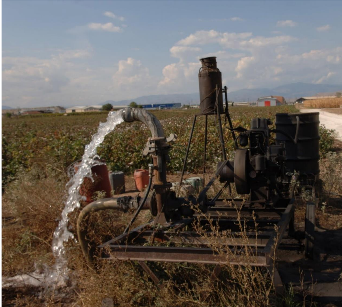
Εικόνα 10. Ένα παλαιό σύστημα άντλησης από αρδευτικό κανάλι (Πηγή: protothema.gr)
