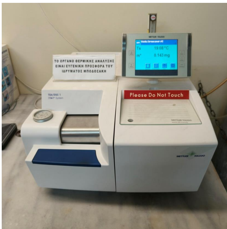
Εικόνα 19: Mettler-Toledo TGA/DSC1 για Θερμοσταθμική Ανάλυση (TGA).
