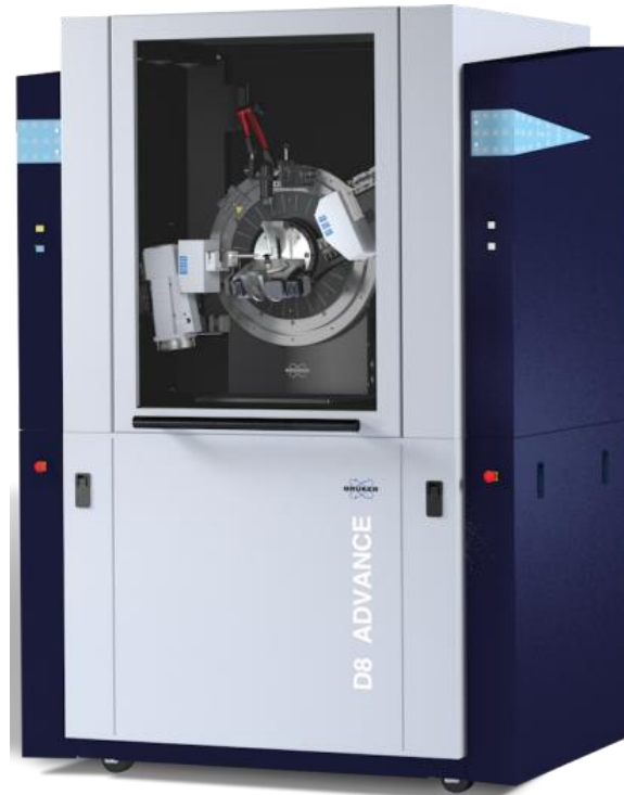
Εικόνα 15: Bruker D8 εξοπλισμένος με ανιχνευτή Lynxeye XE-T για Περίθλαση Ακτίνων X σε Κονιάματα (PXRD) [126].
