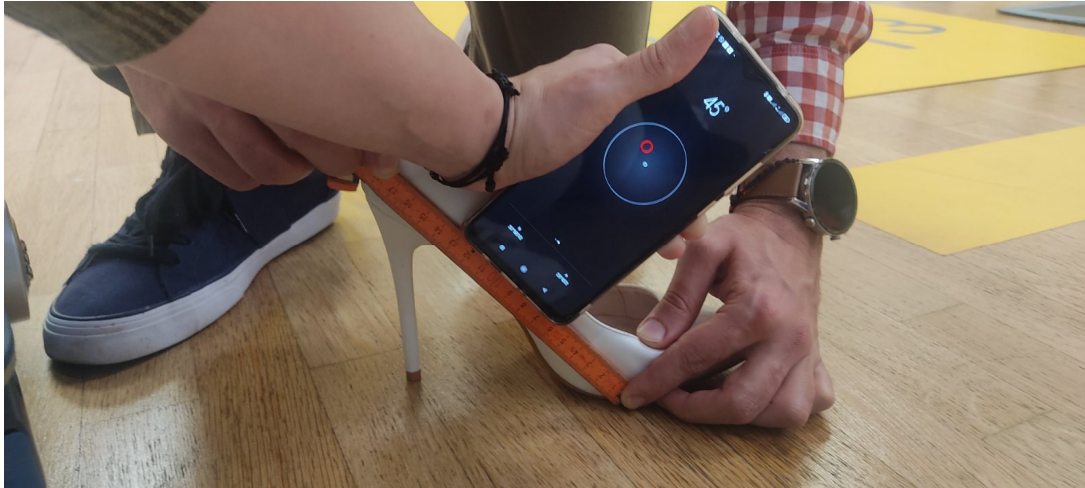
Εικόνα 2.10: Μέτρηση κλίσης με ψηφιακό γωνιόμετρο.
