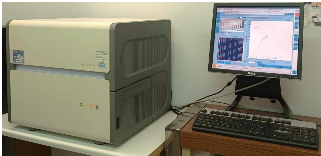
Εικόνα 16: Ο θερμοκυκλοποιητής LightCycler 480 της εταιρείας Roche
