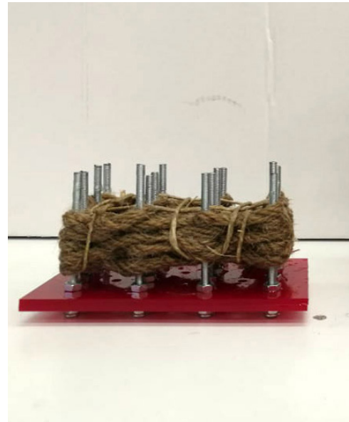
Εικ. 37: Δοκίμιο με ίνες γιούτα στην οριζόντια πλέξη και ίνα κλωστικής κάνναβης στην κάθετη συμπληρωματική σταθεροποίηση (ορθογώνια διάταξη)
