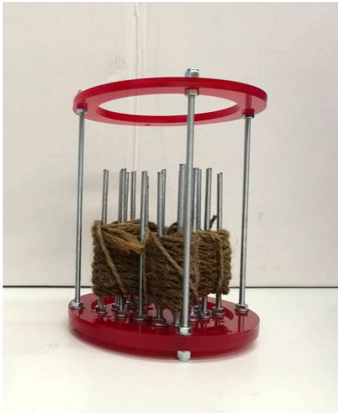
Εικ. 36: Δοκίμιο με ίνες γιούτα στην οριζόντια πλέξη και ίνα κλωστικής κάνναβης στην κάθετη συμπληρωματική σταθεροποίηση (κυκλική διάταξη)
