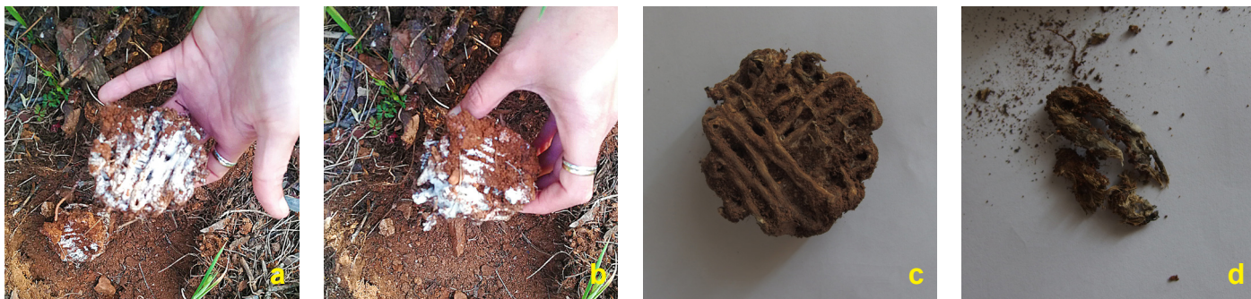
Εικ. 51: a,b: Δοκίμια σε αποσύνθεση κατά τον ενδιάμεσο έλεγχο. c,d: Δοκίμια κατά την αφαίρεση τους από το χώμα μετά το πέρας των 7 μηνών.
