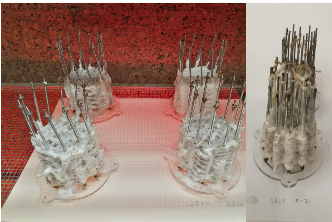
Εικ. 47: Βιο-σύνθετα συμπαγούς πλέξης τοποθετημένα στο ξηραντήριο για αδρανοποίηση του μύκητα και αποξηραμένα δοκίμια κενής πλέξης λίγο πριν την απομάκρυνση τους από τη βάση.
