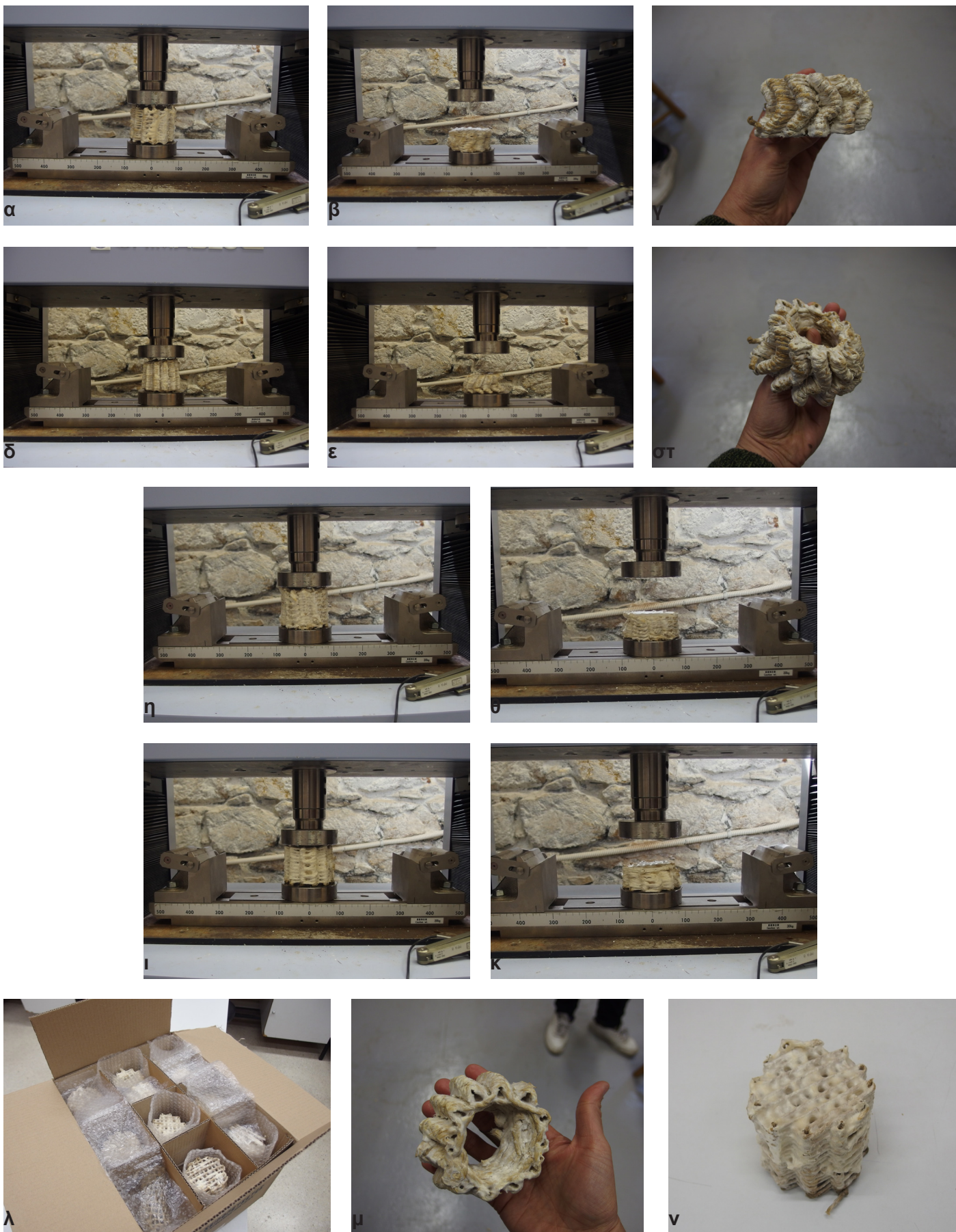
Εικ. 49: (α, δ, η, ι) Δοκίμια τοποθετημένα στη μηχανή θλίψης πριν την έναρξη της δοκιμής, (β, ε, θ, κ) συμπιεσμένα δοκίμια μετά τη δοκιμή θλίψης, (γ, στ, μ) κούφια δοκίμια με το φαινόμενο του λυγισμού μετά τη συμπίεση, (λ) δοκίμια συσκευασμένα και έτοιμα προς αξιολόγηση. (υ) συμπαγές δοκίμιο προ αξιολόγησης.
