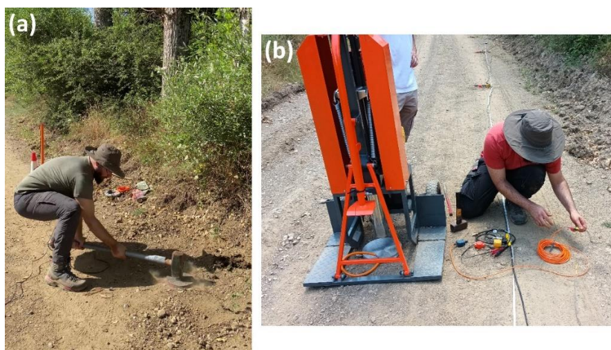
Εικόνα 2.12: (α) Στιγμιότυπο κατά την κρούση της σεισμικής σφύρας (6,5kg) επάνω στη μεταλλική πλάκα. (β) Στιγμιότυπο κατά την προετοιμασία της σεισμικής πηγής AWD-33PS.
