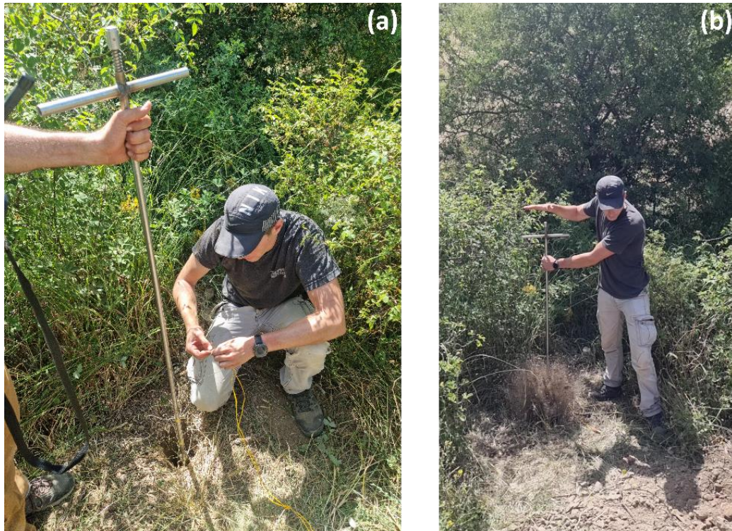
Εικόνα 2.16: Στιγμιότυπα κατά τη διάρκεια πραγματοποίησης της έκρηξης με την σεισμική πηγή buffalo gun . (a) Τοποθέτηση της πηγής, (b) Εκπυροσκόρτηση του αβολιδώτου φυσιγγιού.
