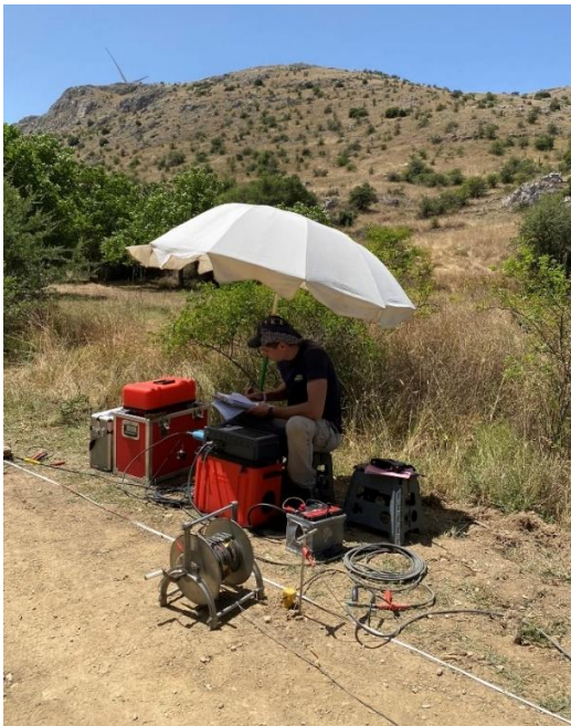
Εικόνα 2.11: Το κέντρο διάταξης του γεωσεισμικού αναπτύγματος SRT 1.
