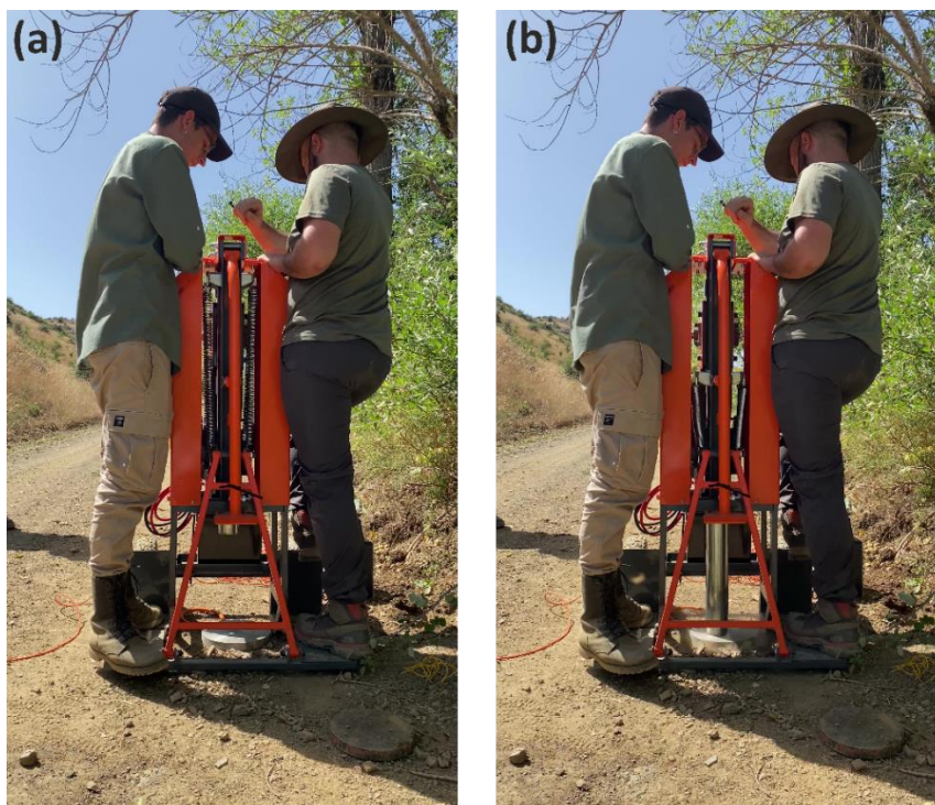
Εικόνα 2.14: Στιγμιότυπο λίγο πριν (α) και αμέσως μετά (β) την κρούση της σεισμικής σφύρας, βάρους 20kg, επάνω στη μεταλλική πλάκα αλουμινίου.
