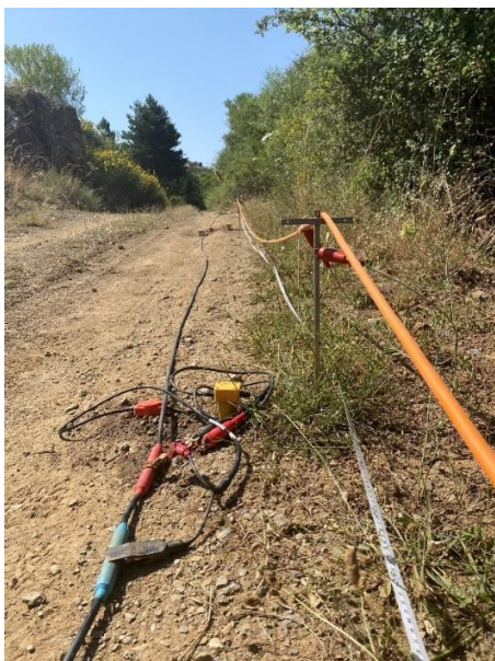
Εικόνα 2.9: Απεικόνιση του γεωσεισμικού (SRT 1) και γεωηλεκτρικού (ERT 3) αναπτύγματος.
