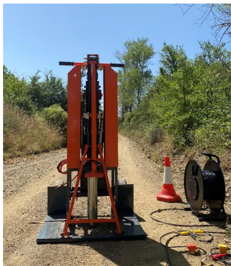
Εικόνα 2.13: Η σεισμική πηγή επιταχυνόμενου πίπτον βάρους 20kg ( AWD-33PS του οίκου Geodevice ), που χρησιμοποιήθηκε στην παρούσα μελέτη.
