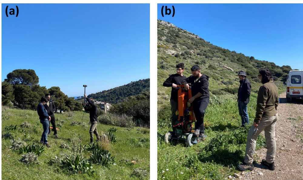
Εικόνα 3.9: (a) Στιγμιότυπα κατά τη διαδικασία λήψης των γεωσεισμικών δεδομένων με τη χρήση (a) της σεισμικής σφύρας (6,5kg) και (b) της σεισμικής πηγής AWD-33PS.
