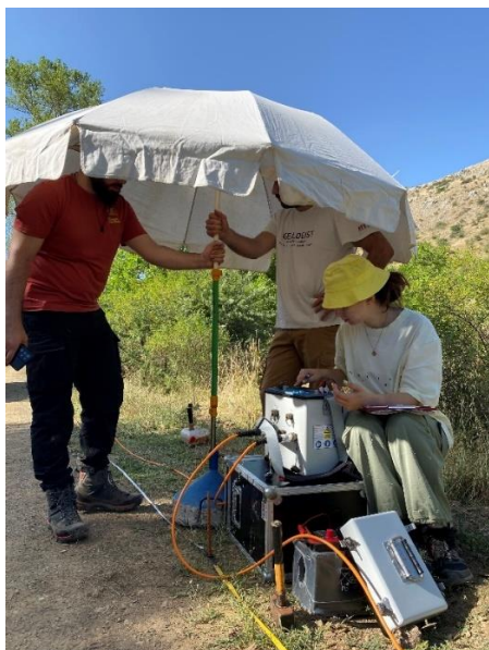
Εικόνα 2.8: Στιγμιότυπο κατά τη διαδικασία λήψης των γεωηλεκτρικών δεδομένων του αναπτύγματος ERT 3.
