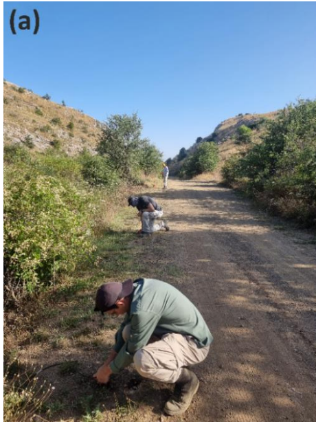
Εικόνα 2.10: Στιγμιότυπα κατά τη διάρκεια προετοιμασίας του σεισμικού αναπτύγματος SRT 1. (a) Πάκτωση σεισμικών δεκτών στο έδαφος. (b) Τοποθέτηση του πολυκαναλικού καλωδίου.
