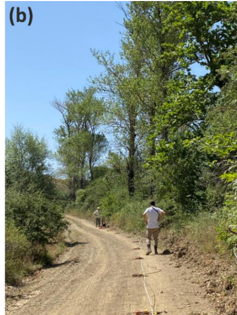
Εικόνα 2.10: Στιγμιότυπα κατά τη διάρκεια προετοιμασίας του σεισμικού αναπτύγματος SRT 1. (a) Πάκτωση σεισμικών δεκτών στο έδαφος. (b) Τοποθέτηση του πολυκαναλικού καλωδίου.
