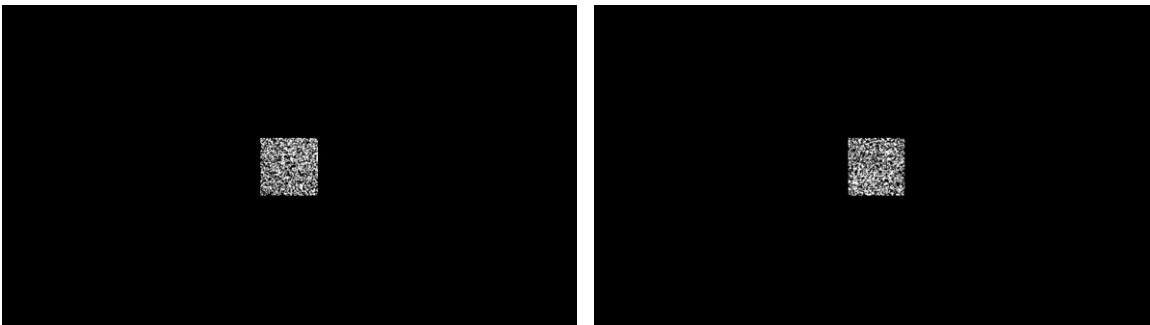
Σχήμα 6.2: Ενδεικτικά παραδείγματα διεγέρσεων με ανάλυση 64x64 micromirrors, εκ των οποίων μόνο το 1/2 του συνολικού πλήθους τους συνεισφέρει στην τελική ακτινοβολή του diffuser.
