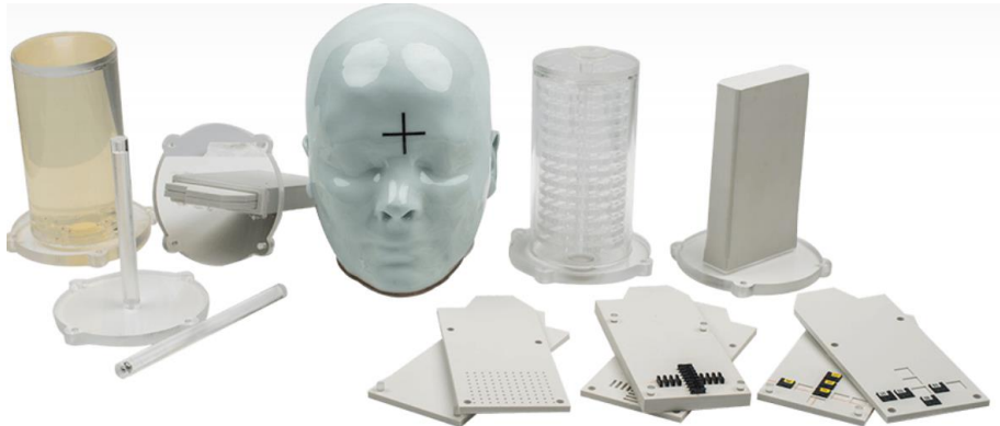
Εικόνα 18α : Το ομοίωμα RT safe Prime, μαζί με ειδικά σχεδιασμένα ένθετα για τοποθέτηση : TLDs, Gafchromic EBT films, OSLDs και πολυμερών γέλης.
