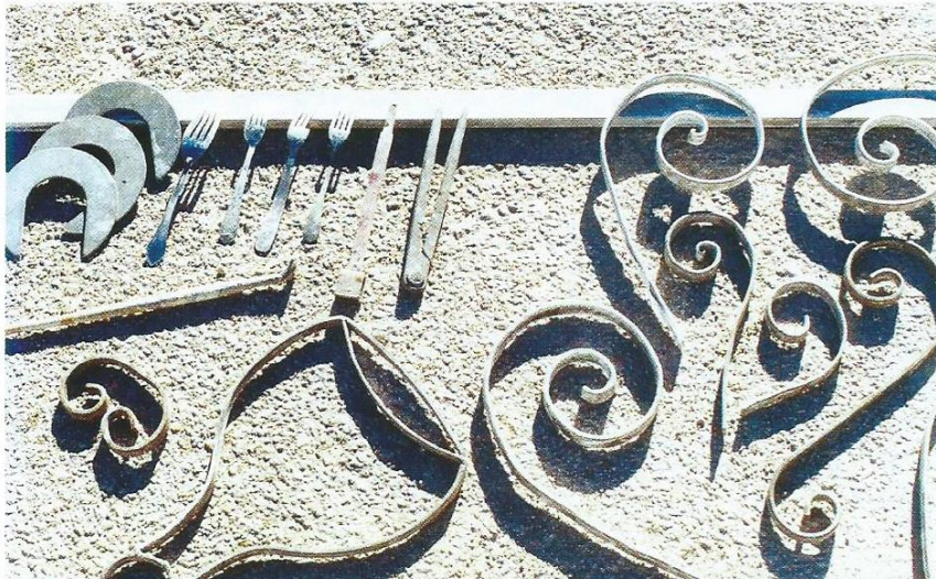
Τα εργαλεία και οι φόρμες για τη χάραξη του ξυστού
