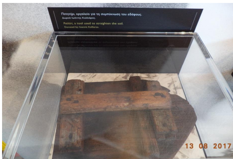
Πατητήρι, εργαλείο για τη συμπίκνωση του εδάφους, για το στρώσιμο της τράπεζας.
