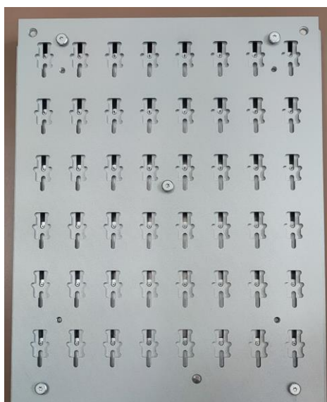
Εικόνα 5.5: Φωτογραφία του συρταρωτού πλαισίου, όπου τοποθετούνται τα 48 δοσίμετρα προς διαγραφή του σήματος.
