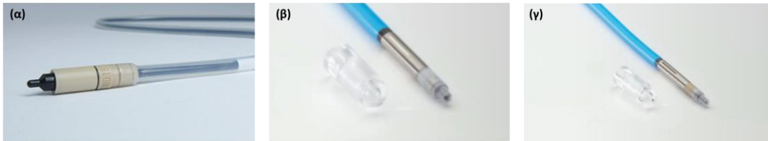
Εικόνα 2.3: Θάλαμοι ιονισμού: (α) Razor Nano Chamber, (β) PinPoint 3D 0.016 cc Type 31025, (γ) PinPoint 0.03 cc Type 31015 [IBA και PTW catalogue].
