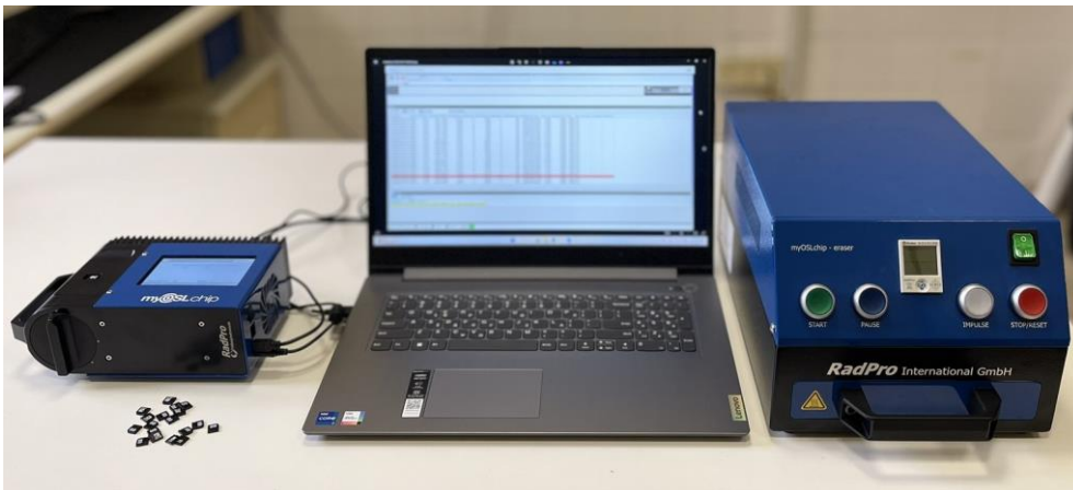
Εικόνα 5.2: Φωτογραφία του βασικού εξοπλισμού BeO OSL δοσιμετρίας: δοσίμετρα BeO, συσκευή ανάγνωσης (reader), υπολογιστής με λογισμικό καταγραφής μετρήσεων και συσκευή διαγραφής σήματος (bleacher) (από αριστερά προς τα δεξιά).
