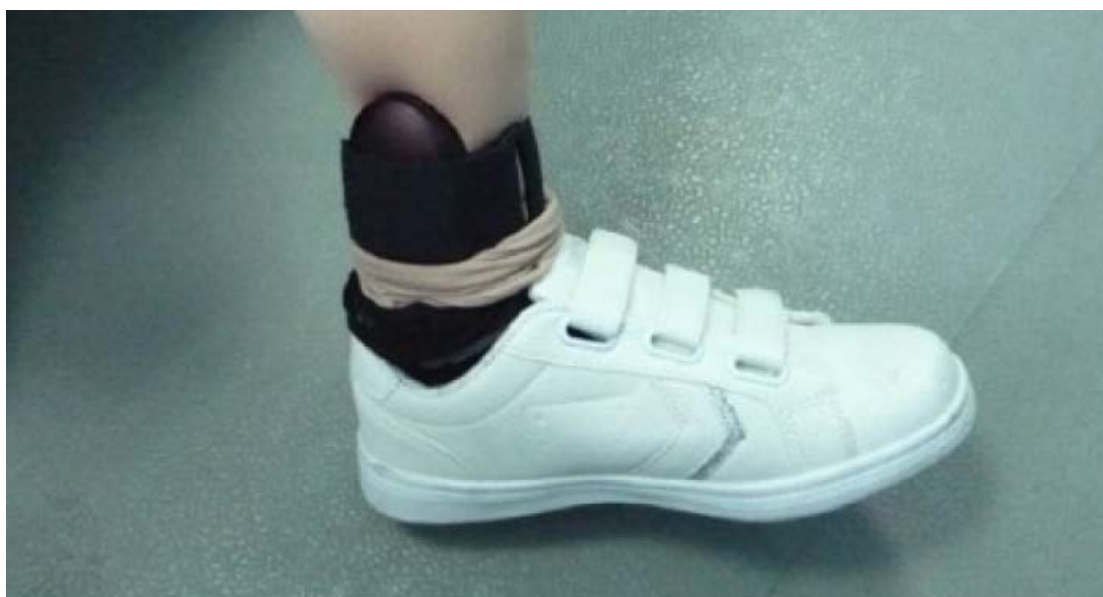
Εικόνα 2: SAM που είναι τοποθετημένο στη ποδοκνημική του προσθετικού άκρου
