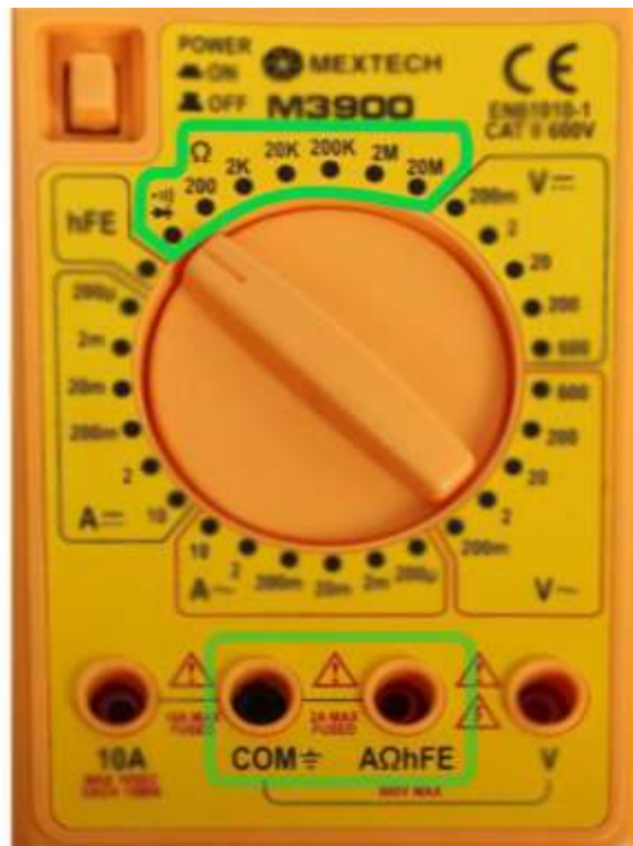
Σχήμα 230 , Επιλογή περιοχής μέτρησης αντίστασης
