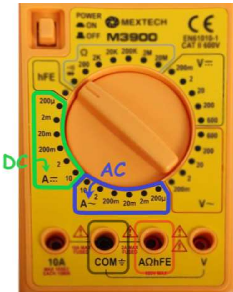
Σχήμα 229 , Επιλογή περιοχής μέτρησης συνεχούς ρεύματος (πράσινο), και εναλλασσόμενου (μπλε)
