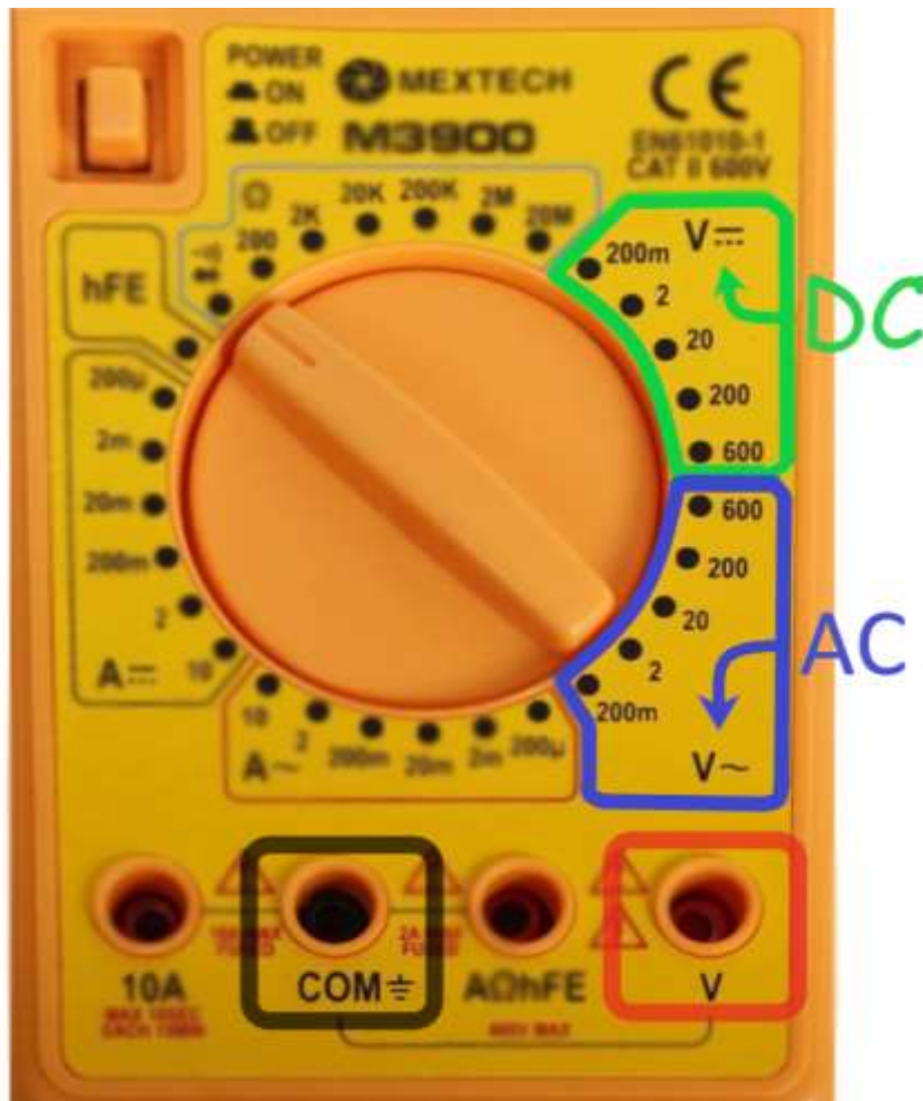
Σχήμα 227, Επιλογή περιοχής μέτρησης συνεχούς τάσης (πράσινο), και εναλλασσόμενης τάσης (μπλε)
