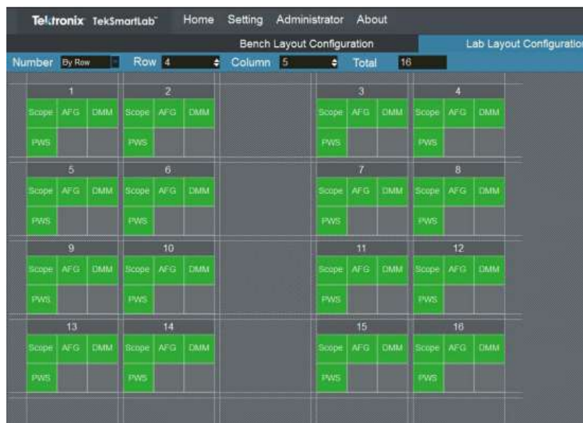
Σχήμα 11 , Προσομοίωση διάταξης φυσικού εργαστηρίου στο TekSmartLab
