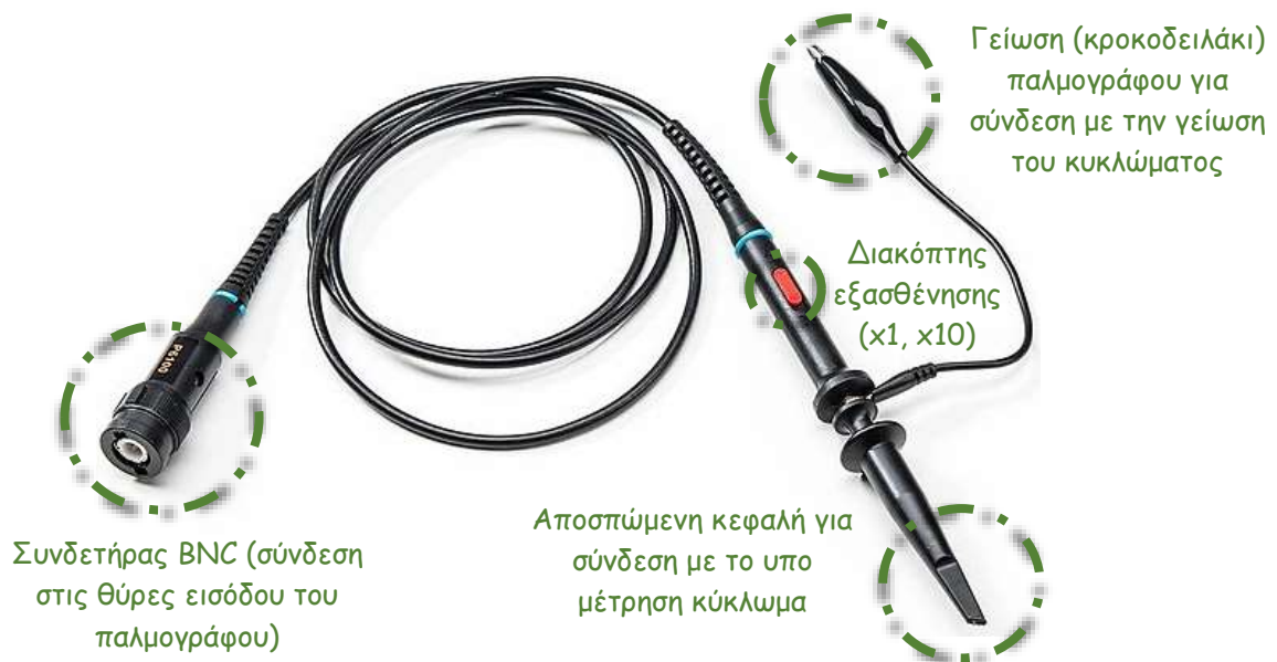
Σχήμα 240 , Επεξήγηση μερών ενός τυπικού Probe παλμογράφου
