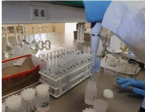
Εικόνα 3.7: α) Προετοιμασία των δειγμάτων για ανάλυση στο ICP-OES και ICP-MS. β) Φωτογραφία με την προετοιμασία νέου πρότυπου διαλύματος Mn 1ppm για τον έλεγχο ευαισθησίας του οργάνου στο ICP-OES.
