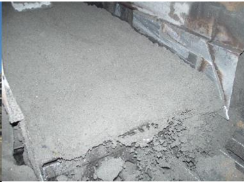
Εικόνα 2.12: α) Σύστημα αποκομιδής αναμειγμένης υγρής, ιπτάμενης τέφρας και γύψου πριν οδηγηθούν με φορτηγά στην απόθεση. β) Υγρή τέφρα πυθμένα που έπειτα οδηγείται σε κλειστού τύπου ταινίες.
