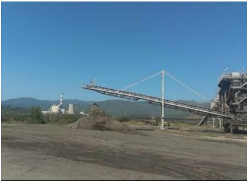
Εικόνα 2.12: α) Σύστημα αποκομιδής αναμειγμένης υγρής, ιπτάμενης τέφρας και γύψου πριν οδηγηθούν με φορτηγά στην απόθεση. β) Υγρή τέφρα πυθμένα που έπειτα οδηγείται σε κλειστού τύπου ταινίες.
