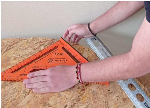
Εικόνα 14. Χάραξη εγγεγραμμένης γωνίας 90 μοιρών.
