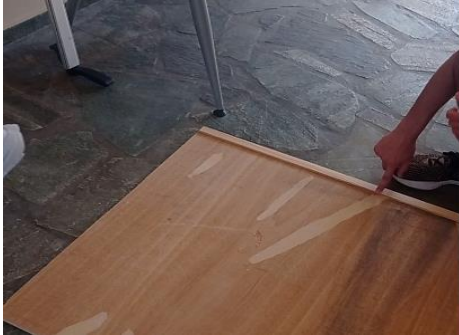
Εικόνα 21. Χρήση βοηθητικού τεμαχίου αντί μετροταινίας για τον υπολογισμό μήκους
