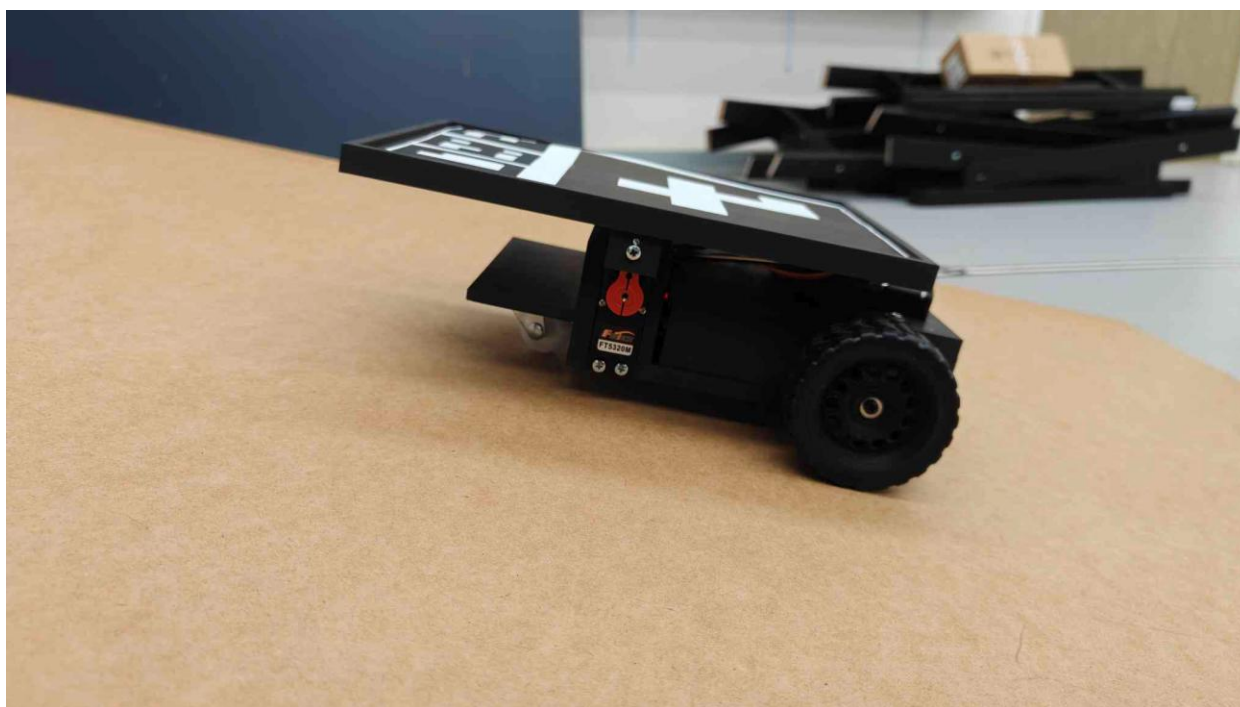
Εικόνα 6.2 Όχημα σε κλίση, χωρίς αυτόματη εξισορρόπηση.
